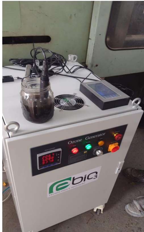
Gerador de ozônio do módulo de testes e analisador multi parâmetros
