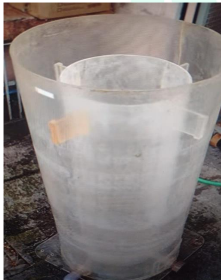
Tanque reator do módulo de teste
